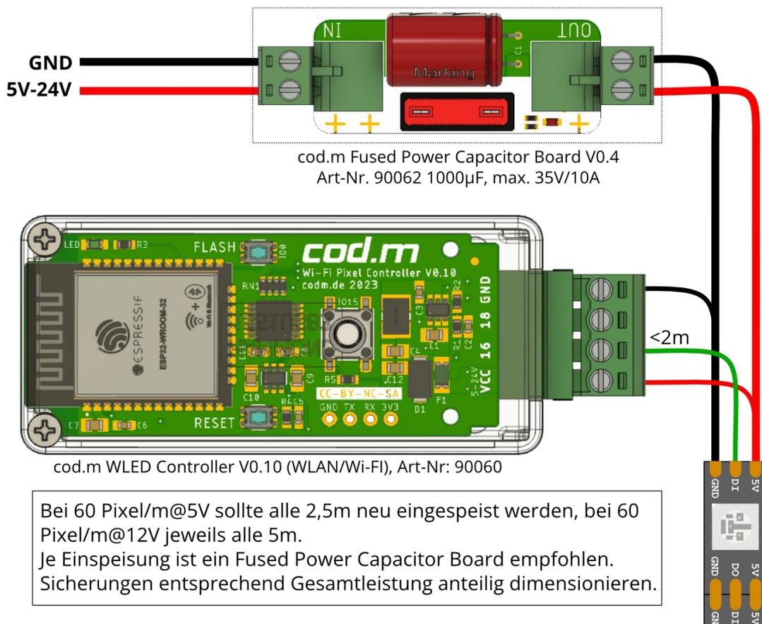
Abbildung 1 - Verdrahtung am Beispiel WS281x, 5-24V
